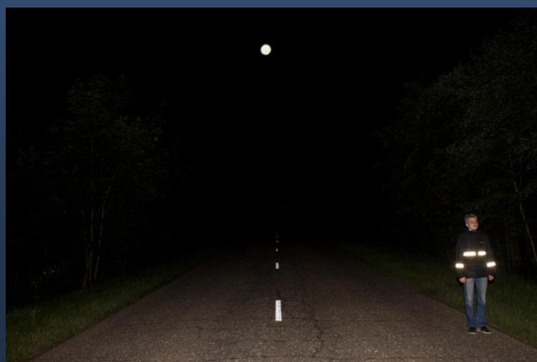
**Выводы:** Пешехода с несъемными световозвращателями (СВ-лентами, нашитыми на куртку) на неосвещенной дороге в дальнем свете фар автомашины заметно более чем с 350 м.
