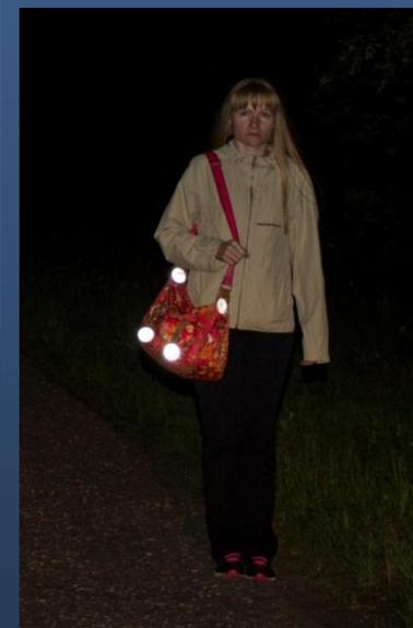
**Выводы:** Пешехода со световозвращателями (брелоками и значками на сумке) на неосвещенной дороге в дальнем свете фар автомашины заметно более чем с 350 м.
