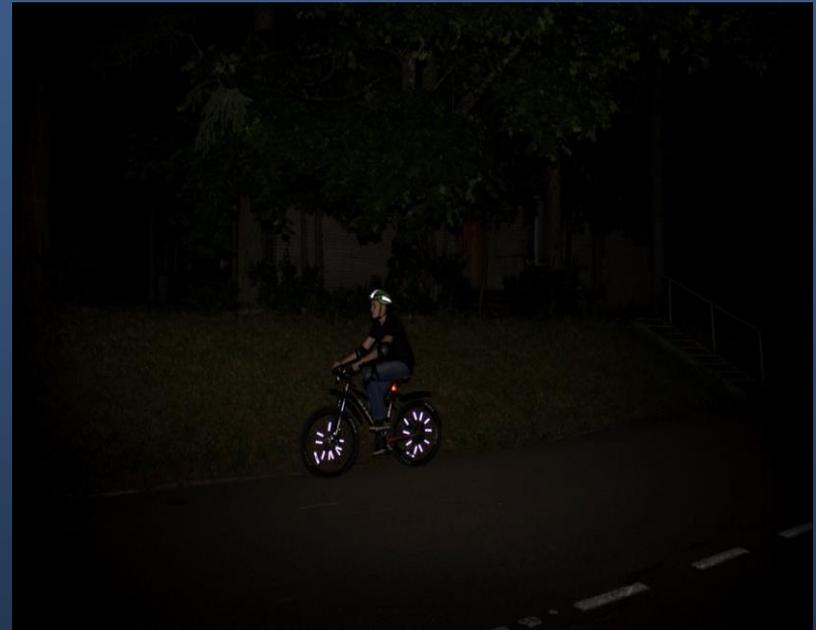
**Выводы** : Такая комбинация световозвращателей делает велосипедиста хорошо заметным только в боковой проекции. Однако спереди и сзади его видимость недостаточна. Частичная оснащённость велосипедиста не обеспечивает необходимую и достаточную заметность его на дороге.
